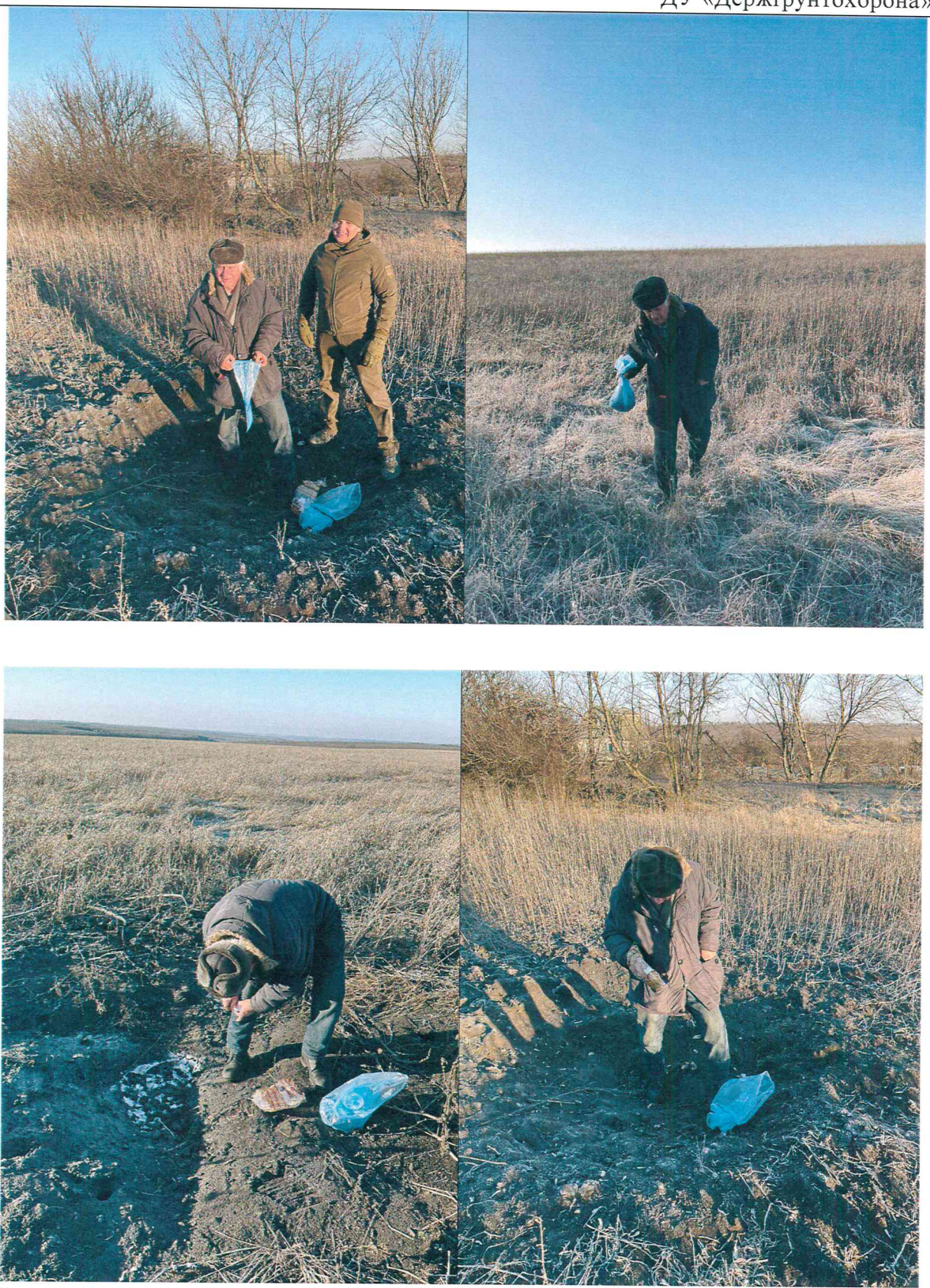
Рис. 9. Відбір зразків ґрунту (с. Токарівка Друга, вирва від міни)
